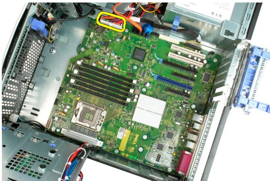
12. Odpojte dátové káble optickej jednotky a pevného disku.
